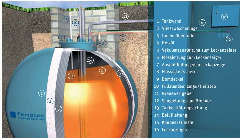
Komponenten einer fenosafe®-Leckschutzauskleidung
